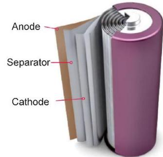
Le principe de fonctionnement n'est donc pas si différent de celui des autres batteries. Elle utilise cependant d'autres matériaux, tels que le lithium<sup>1</sup>, qui sont souvent très réactifs et inflammables (tout comme l'électrolyte et le séparateur qui doit empêcher les pôles de se toucher), mais en substance, il y a peu de différence avec les autres batteries rechargeables.
